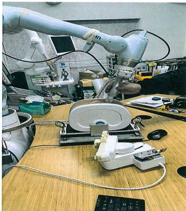
圖七、實作超音波輔助穿刺手術機器人系統
