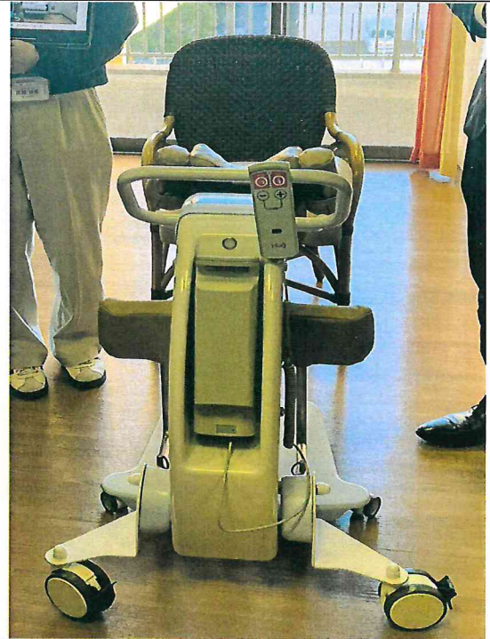
圖四十三、Fuji Machine 輔助站立/移位機
