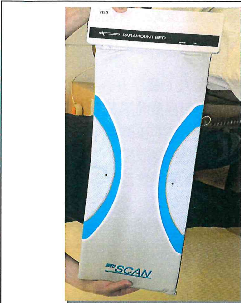
圖十七、心跳、呼吸與離床感測器
